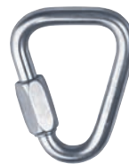
K82210Z MAILLON BIG DELTA Ø 10 mm ■ 45 kN Gate open. (d) 12 mm zinc-plated Weight: 153 g ■ 5.4 oz CE 0082 ■ EN 362 EN 12275
