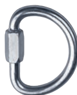
K82310Z MAILLON BIG D Ø 10 mm ■ 45 kN Gate open. (d) 10 mm zinc-plated Weight: 153 g ■ 5.4 oz CE 0082 ■ EN 362 EN 12275 ■
