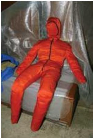
**Манекен имитационный тренировочный «МИТя»** предназначен для отработки действий по поиску и спасению людей в зоне чрезвычайных происшествий. Манекен обладает рядом существенных преимуществ по сравнению с известными аналогами и обеспечивает эффективность учебного процесса в соответствии с современными требованиями подготовки специалистов. **Вес манекена** может меняться по желанию заказчика (от 30 до 70 кг).
