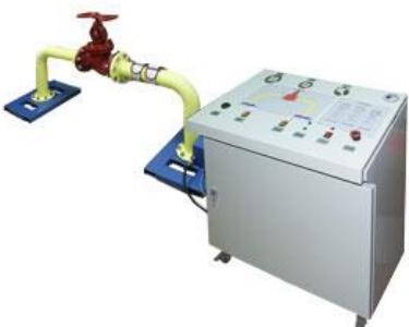
**Тренажер "Утечка из трубопровода"** предназначен для подготовки специалистов по устранению утечек из газопроводов при проведении аварийно-восстановительных работ на предприятиях нефтехимического, химического и газового комплекса, в металлургической промышленности и коммунальных службах, а также подразделениях МЧС России. Стенд не имеет аналогов в России, обладает рядом
